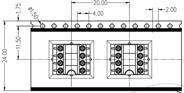
**No.2:** 将产品放入载带凹槽后,用盖带封装
